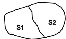
S en équilibre  $\Rightarrow \left\{ \begin{matrix} T_{\vec{S} \rightarrow S} \end{matrix} \right\} = \{0\} \Rightarrow \left\{ \begin{matrix} T_{\vec{S} \rightarrow S1} \\ T_{\vec{S} \rightarrow S2} \end{matrix} \right\} = \{0\} \quad (1)$
