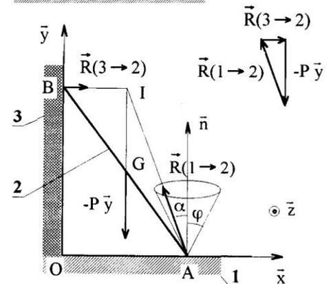
$\vec{R}_{3 \rightarrow 2}$  et  $\vec{P}$  étant concourants au point  $I$ ,  $\vec{R}_{1 \rightarrow 2}$  a pour droite d'action (AI). Si l'inclinaison  $\alpha$  de ce glisseur par rapport à la verticale reste inférieure à l'angle d'adhérence limite  $\varphi$ , l'échelle reste en équilibre quel que soit son poids.
