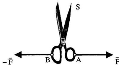
$$\sum \{T_{ext \rightarrow S}\} = \begin{matrix} A \\ \begin{pmatrix} \vec{F} \\ \vec{0} \end{pmatrix} \end{matrix} + \begin{matrix} B \\ \begin{pmatrix} -\vec{F} \\ \vec{0} \end{pmatrix} \end{matrix} = \begin{matrix} A \\ \begin{pmatrix} \vec{F} \\ \vec{0} \end{pmatrix} \end{matrix} + \begin{matrix} A \\ \begin{pmatrix} -\vec{F} \\ \vec{0} \end{pmatrix} \end{matrix} = \begin{matrix} A \\ \begin{pmatrix} \vec{0} \\ \vec{0} \end{pmatrix} \end{matrix} = \{0\}$$
